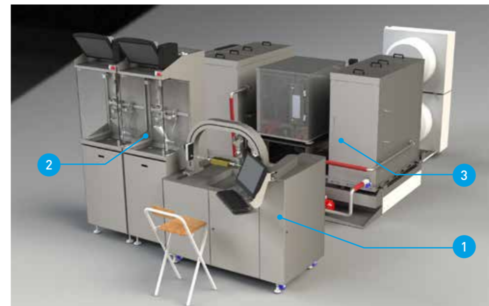
1 - Leistungsprüfstand 2 - Dauerbelastungsprüfstand 3 - Warmwasser/ Kaltwassergenerator
