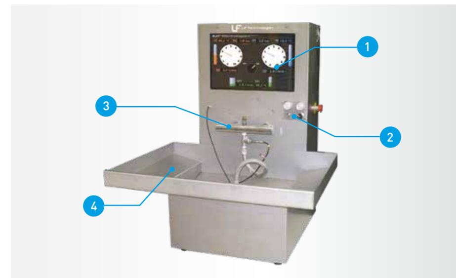
1 - Bedienpult 2 - Steuerung des Warmwasser-/Kaltwasserdrucks 3 - Getestete Armatur 4 - Spülbecken
