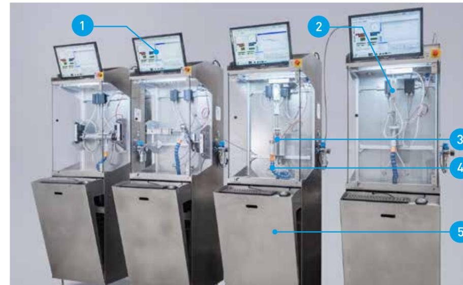
1 - Steuerungs-PC 2 - Auslöser 3 - Getestete Armatur 4 - Wasserrückgewinnung 5 - Gestell aus rostfreiem Edelstahl
